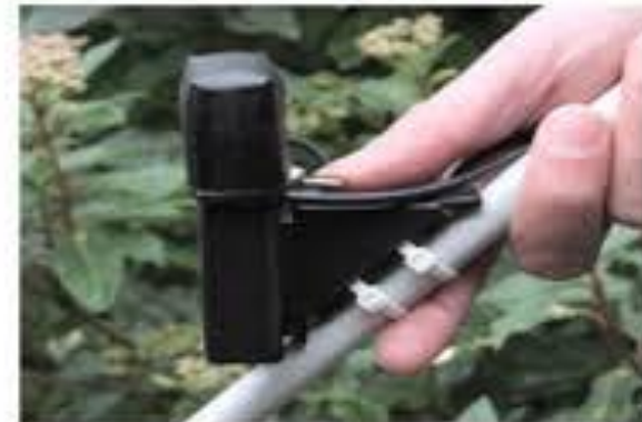
Le système électronique de la canne blanche
